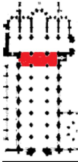
Porção de abóbada compreendida entre dois suportes (pilares, colunas, etc.)
