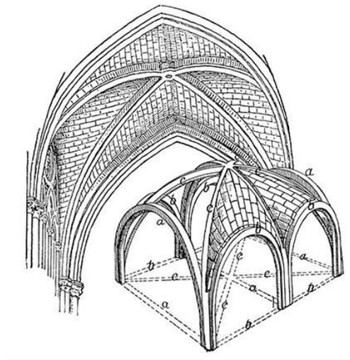
Elemento fundamental da abóbada gótica, formado pelo cruzamento em diagonal de dois arcos ou nervuras, que constituem o tramo, sobre a qual assentam as aduelas dos vários panos da abóbada.
