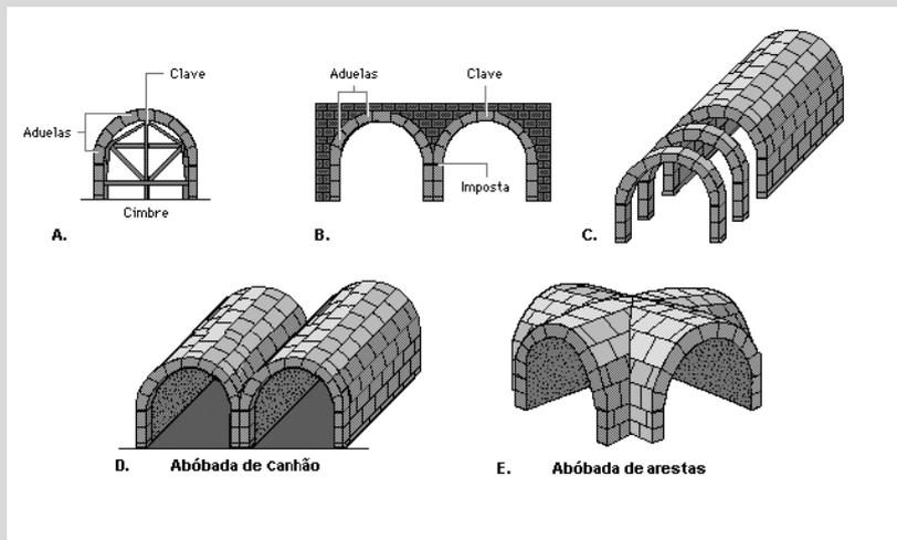
Construção arqueada de pedras aparelhadas, destinada a cobrir um espaço entre duas paredes paralelas. A parte exterior da abóbada é designada por extradorso e a interior por intradorso. Há abóbadas simples e abóbadas compostas (formadas por várias abóbadas simples).
