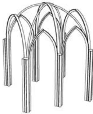
Cada secção é composta por uma armação constituída por duas nervuras cruzadas diagonalmente, duas nervuras frontais de lado a lado da parede e duas nervuras laterais.
