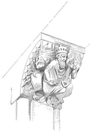
Elemento saliente de uma superfície vertical (parede, pilar, etc) de forma e situação variadas, normalmente pequeno, utilizado como suporte de arco, de varanda, de estátua, etc..
